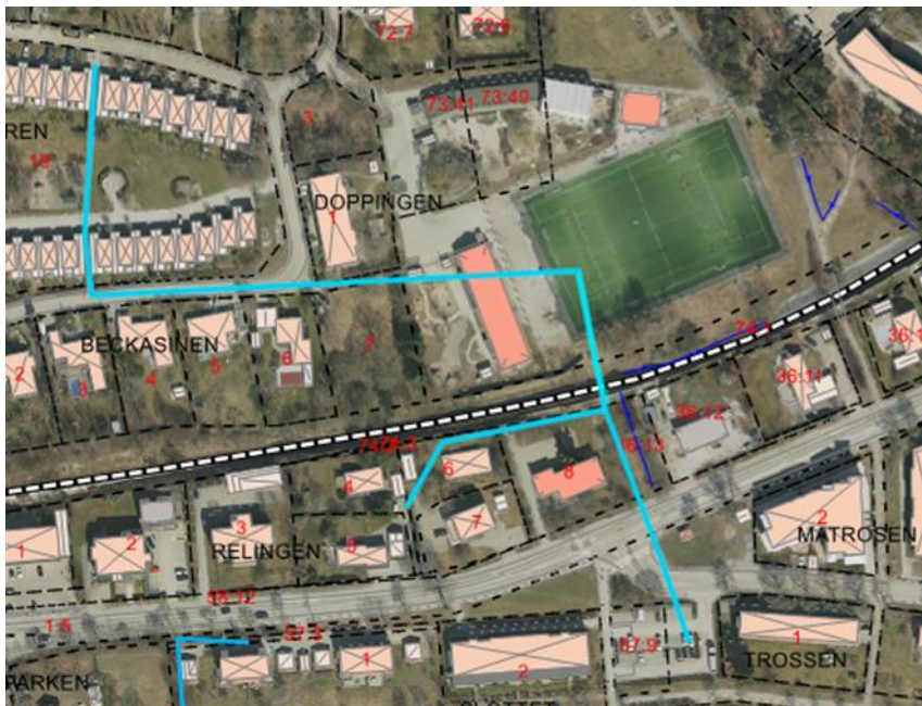
Figur 11: Spillvattenledningar i behov av uppdimensionering.
